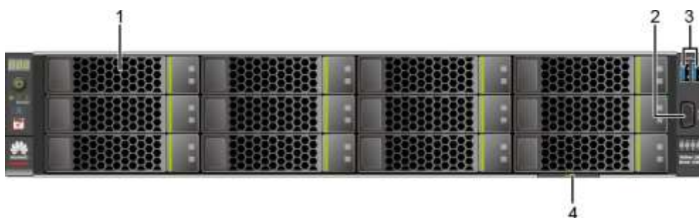
图 2-1 12x3.5 英寸硬盘配置前面板组件
