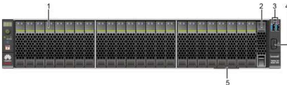
图 2-4 24x2.5 SAS/SATA 硬盘直通配置前面板组件
