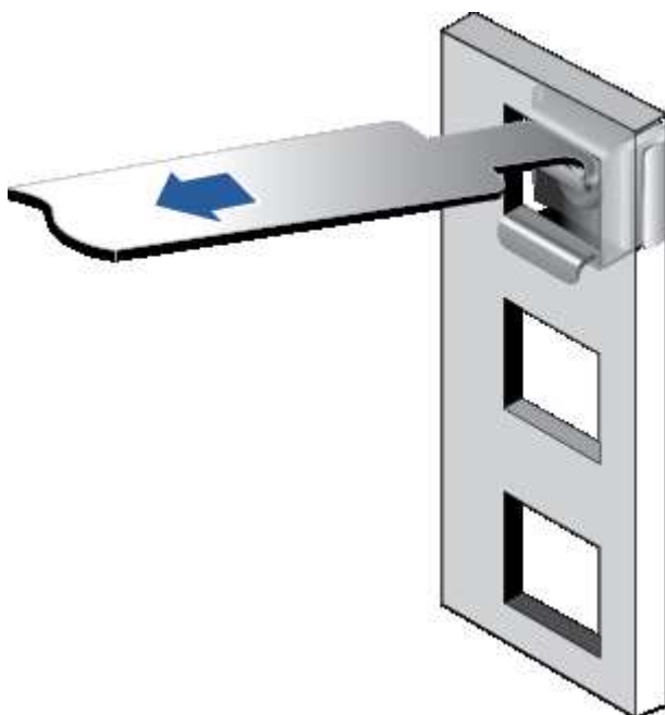
图 5-5 在机柜中安装浮动螺母
