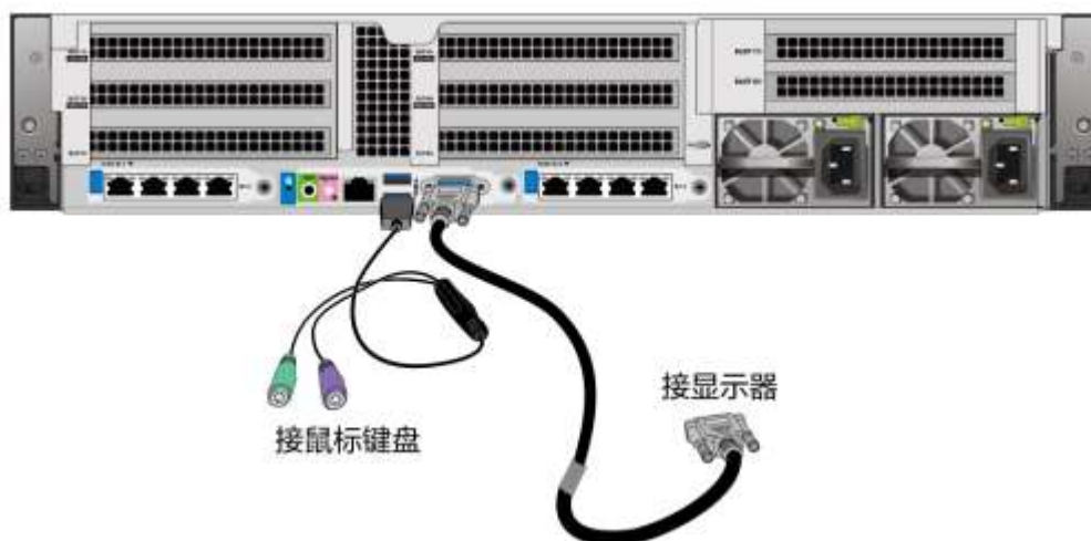
图6-16 连接 USB 转 PS2 线缆和 VGA 接口
