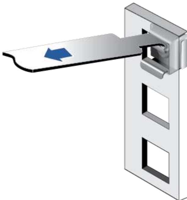
图6-5 在机柜中安装浮动螺母
