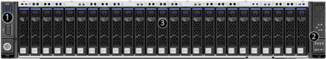
图 3-2 25x2.5 英寸硬盘配置前面板组件
