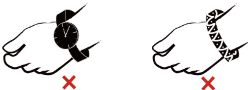
图6-1 去除易导电的物体
