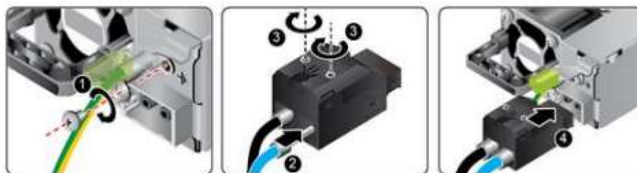
图6-22 连接电源线缆（2000W 电源模块）
